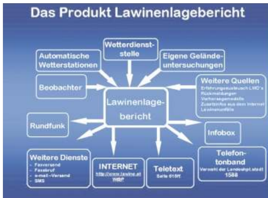
Abbildung 1: Schema der Lawinenlageberichtserstellung
